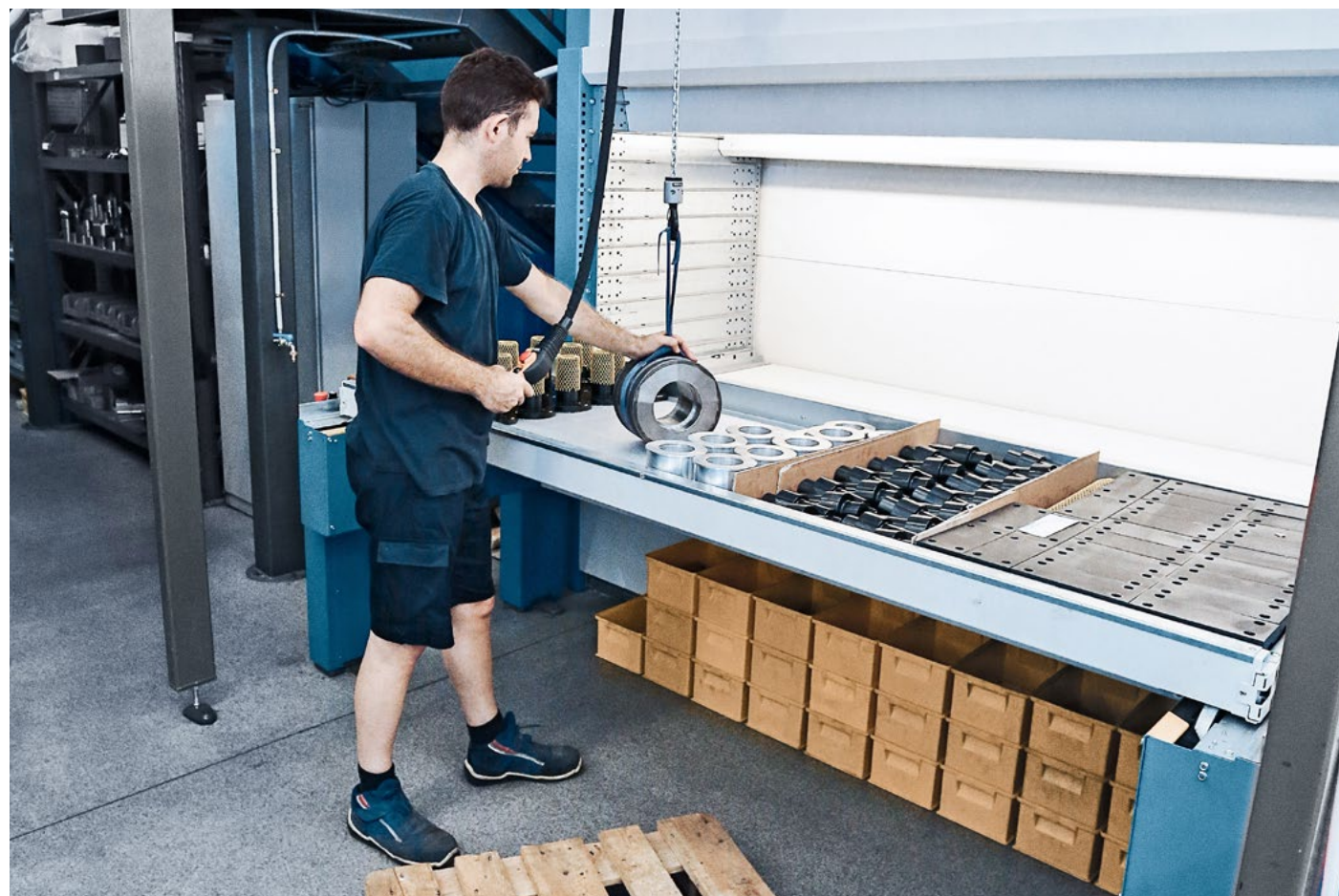
Vertical Lift Module Kardex Shuttle 1000 con gru di sollevamento integrata
