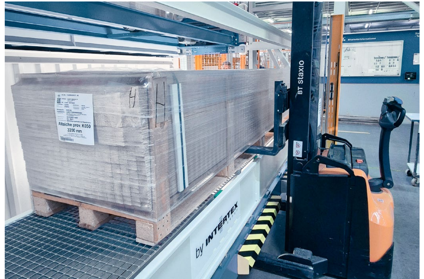
Il doppio fondo del vassoio consente di stoccare pallet di diverse dimensioni
