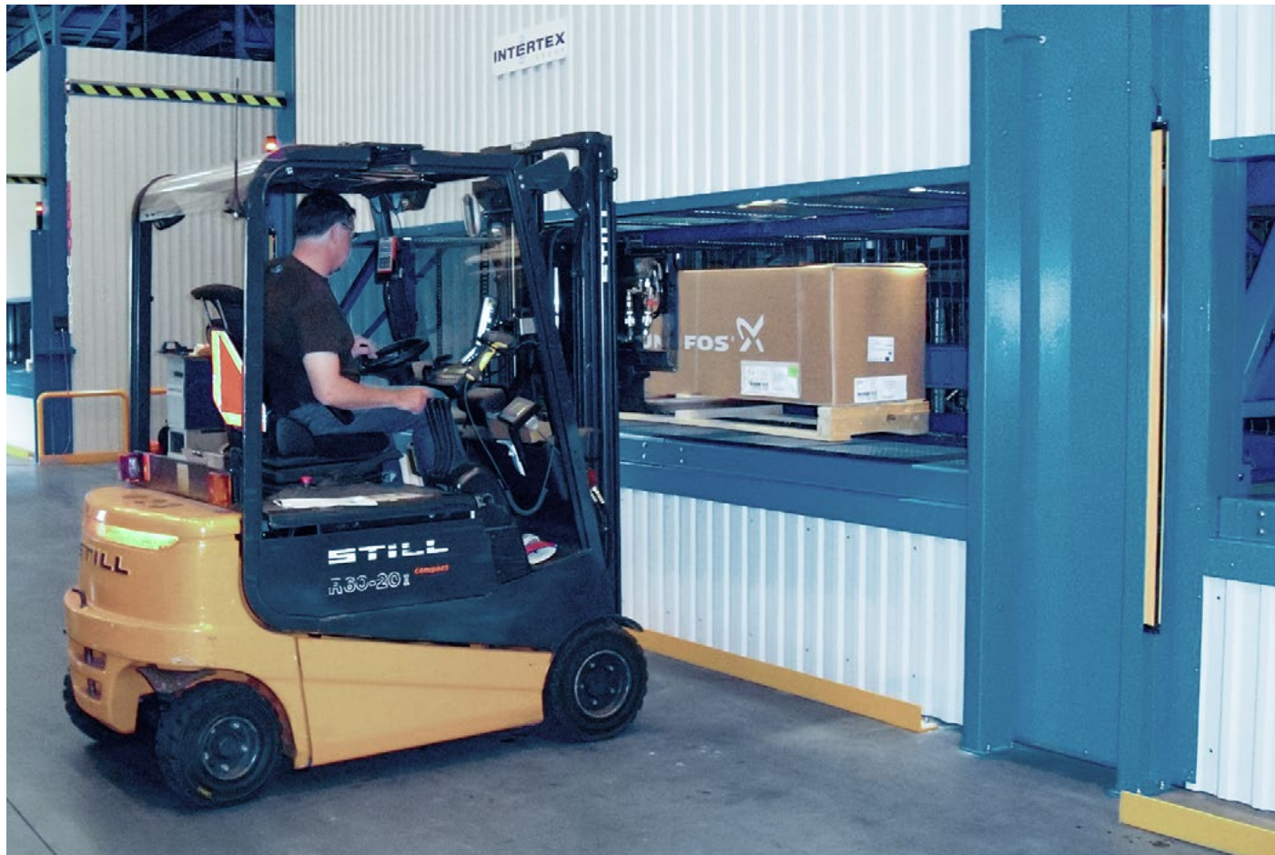
I pallet possono essere facilmente stoccati e prelevati tramite la stazione di sollevamento/abbassamento integrata
