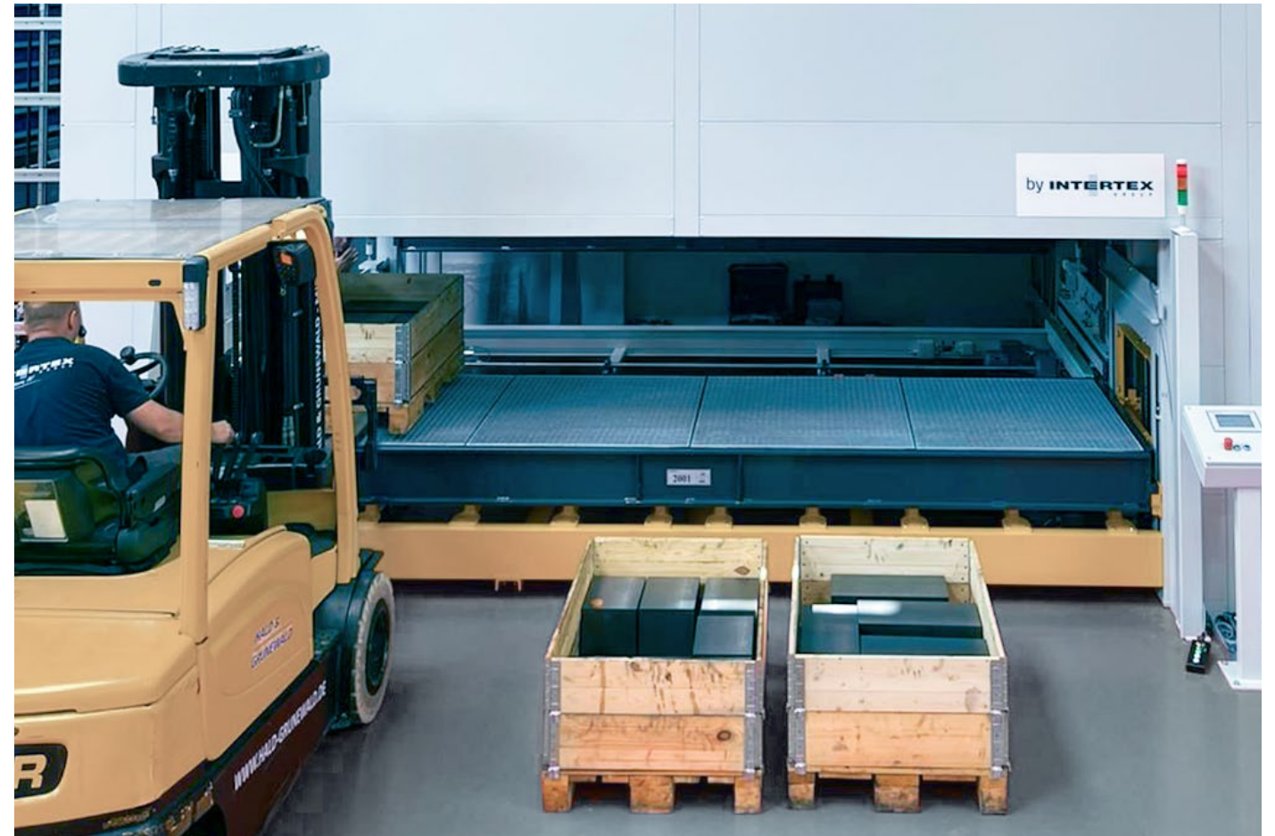
Stoccaggio di più Euro-pallet affiancati con una larghezza del vassoio da 3,5 m a 8,0 m
