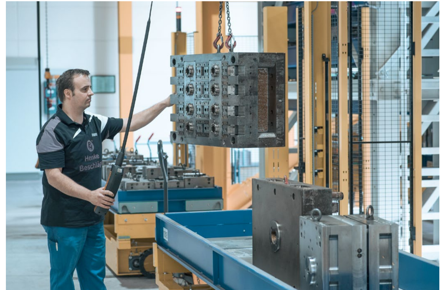
Carico/scarico sicuro di utensili e stampi tramite gru a bandiera o gru a ponte
