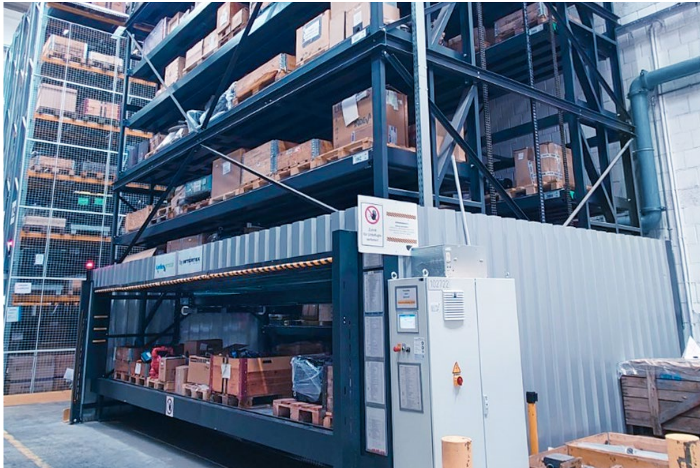
Pieno utilizzo dello spazio sul vassoio grazie a una portata di 5.000 kg
