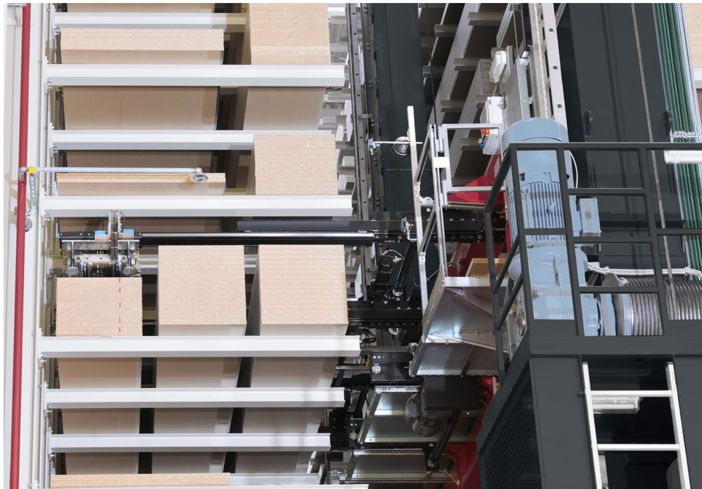
Płyty są pobierane bezpośrednio w magazynie za pomocą chwytaków podciśnieniowych
