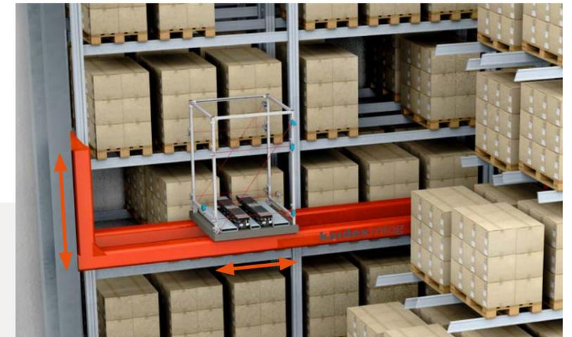
Der Verteilerwagen fährt über den Hubbalken die Palettenstellplätze in den verschiedenen Ebenen an.
