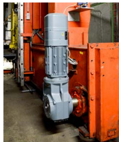
Die vier über 20 Jahre alten Regalbediengeräte erhielten nicht nur neue S7-Steuerungen und neue Antriebe, sondern auch ProfibusSchnittstellen, TCP/IP und Datenlichtschranken zur Datenübertragung.
