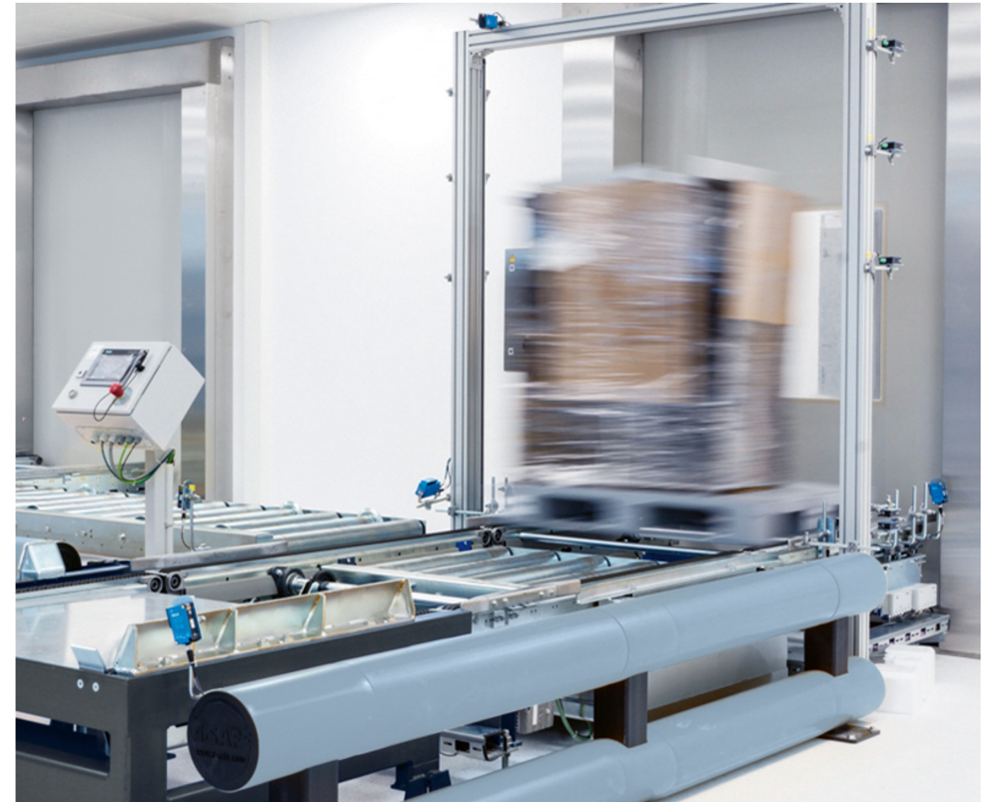
Les salles blanches sont séparées efficacement des zones grises et noires par des portes rapides.
