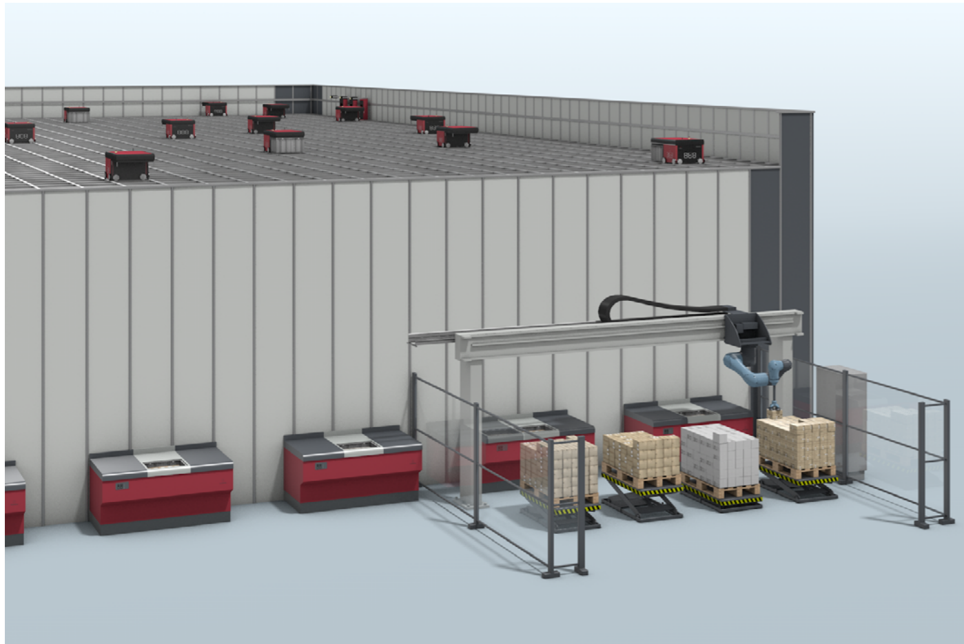
Solution automatisée avec robotique de picking et de dépose pour la (dé)palettisation
