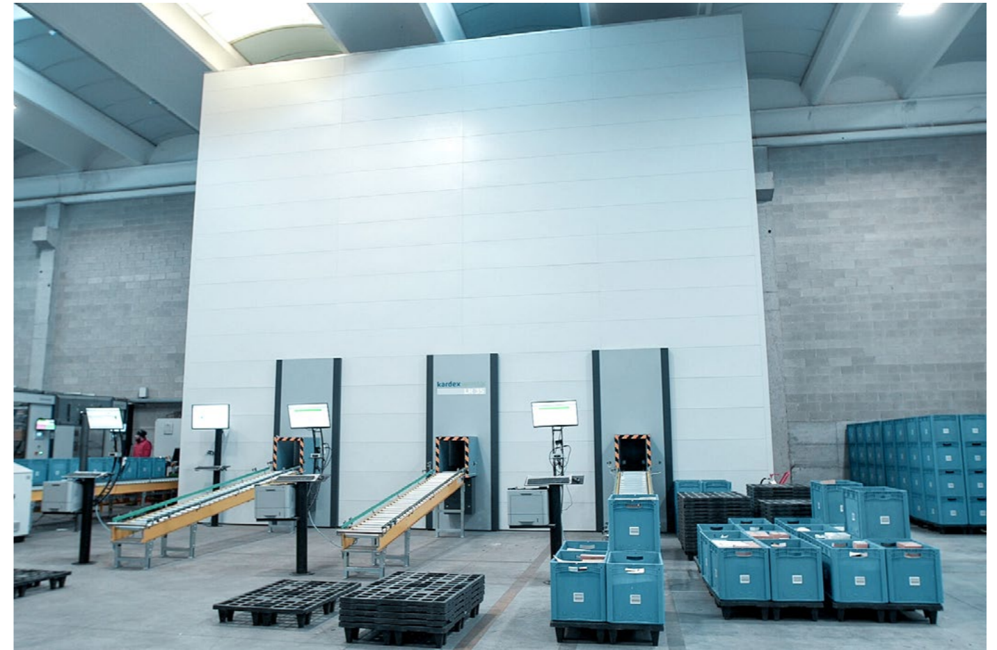
Un Kardex Miniload-in-a-Box funge da buffer di consolidamento con tre aperture per contenitori.
