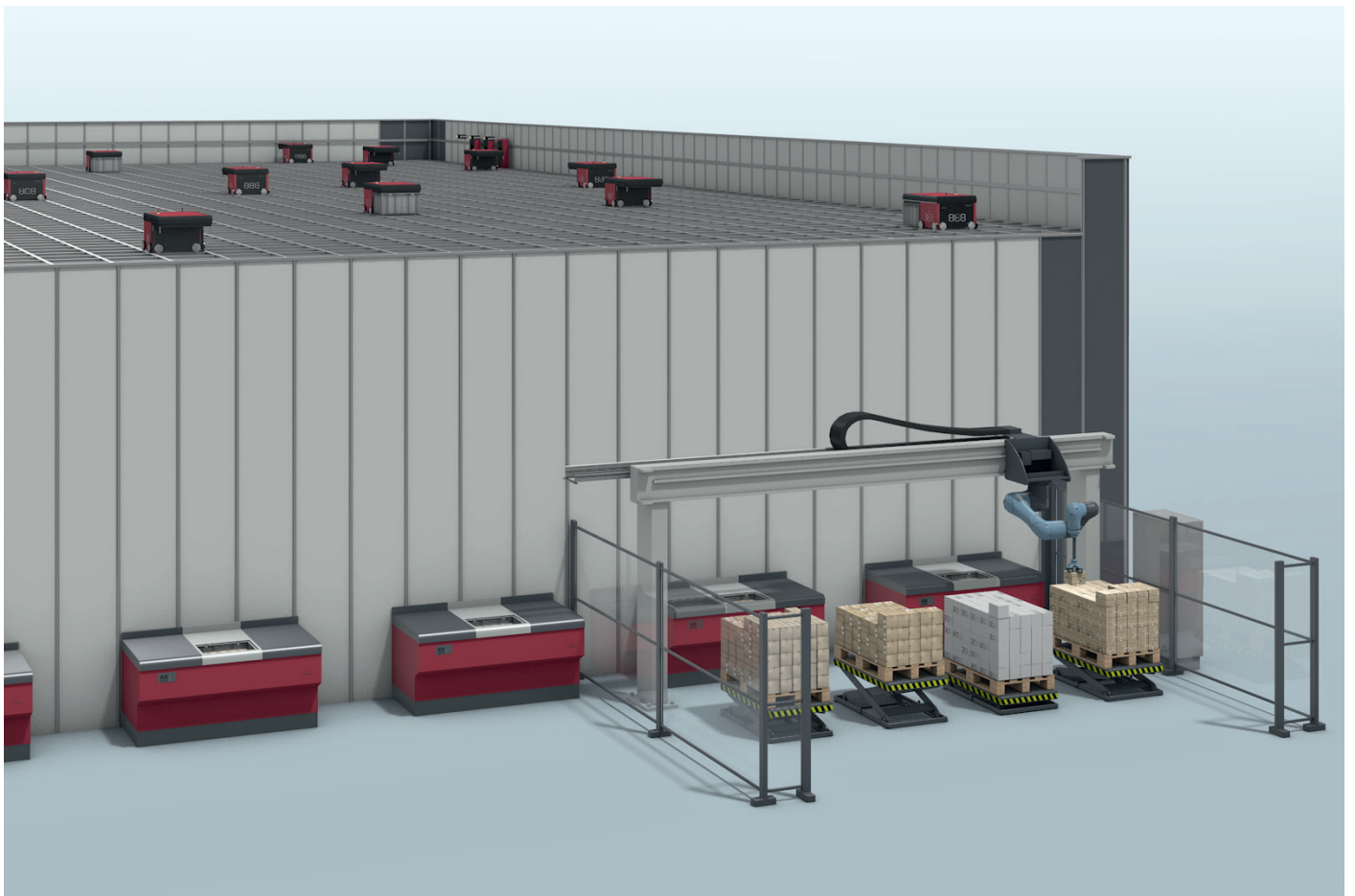
팔레타이징을 위한 픽 앤 플레이스 로봇틱스 자동화 솔루션
