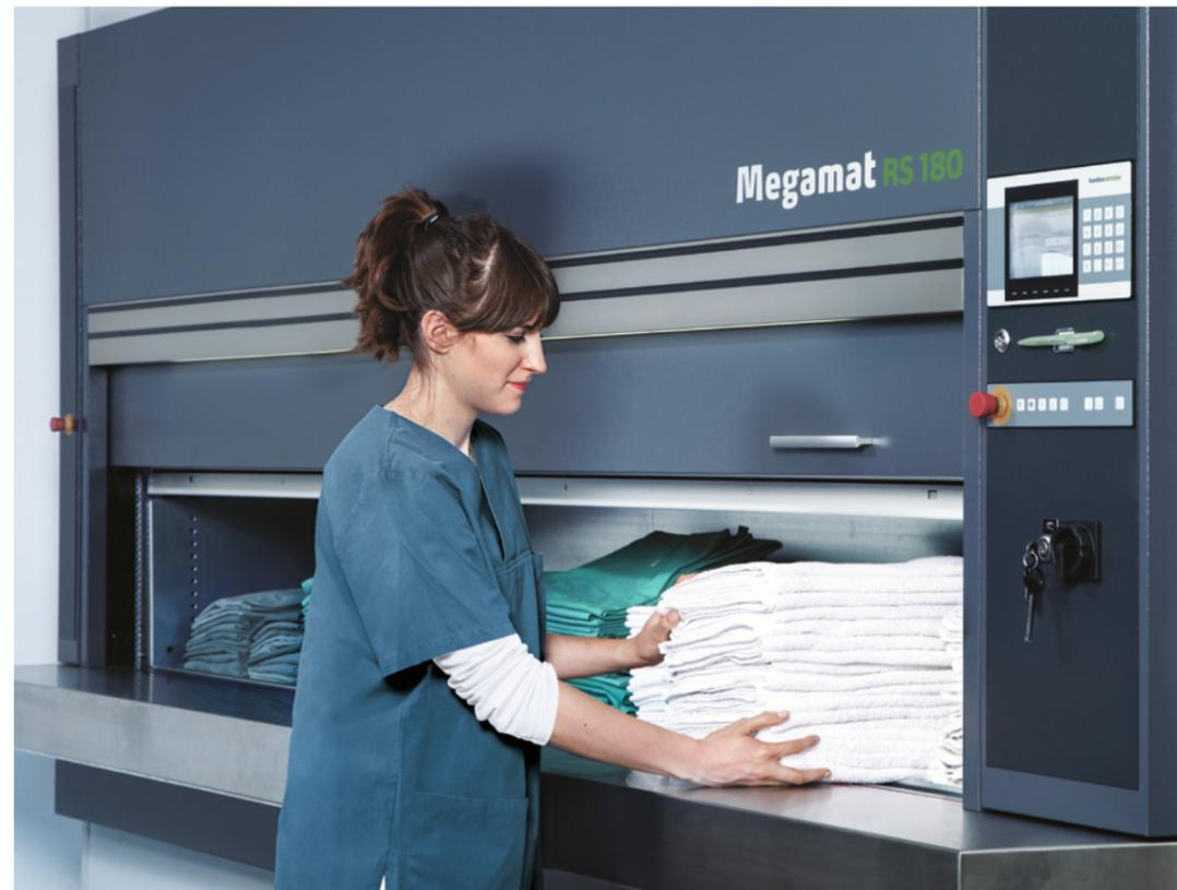
I Vertical Carousel Module sono costituiti da una serie di supporti connessi in posizioni fisse a una trasmissione a catena. Il movimento dei ripiani in entrambi i sensi avviene attraverso una puleggia azionata da un motore. Gli articoli vengono stoccati o prelevati mediante una bocca di accesso ergonomica dove è presente un piano di lavoro.
