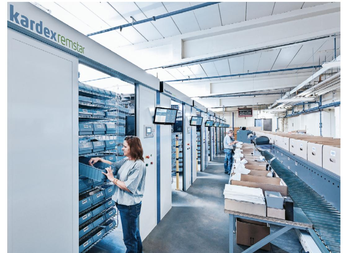
Un Horizontal Carousel Module est composé de nacelles avec des étagères tournant sur un convoyeur horizontal. Un moteur situé à l'intérieur entraîne les nacelles sur le convoyeur horizontal et les arrête à un point d'accès prédéfini pour le stockage ou le prélèvement des produits.
