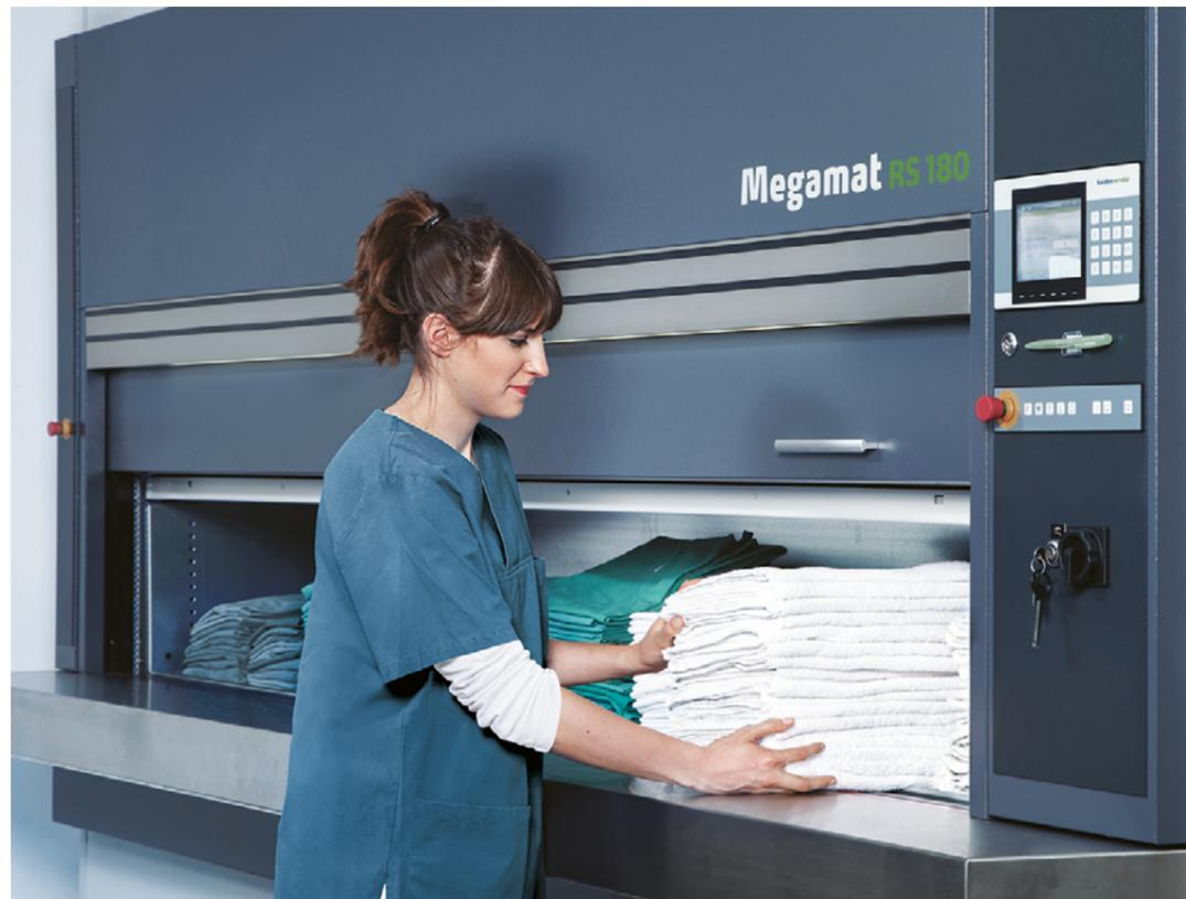
Les Vertical Carousel Module sont un ensemble de plateaux de stockage reliés à une transmission par chaîne. Le mouvement est actionné par un moteur qui déplace les plateaux dans une boucle verticale en marche avant ou en marche arrière, comme une grande roue. Les produits sont stockés ou prélevés par une ouverture d'accès positionnée de manière ergonomique avec un poste de travail.
