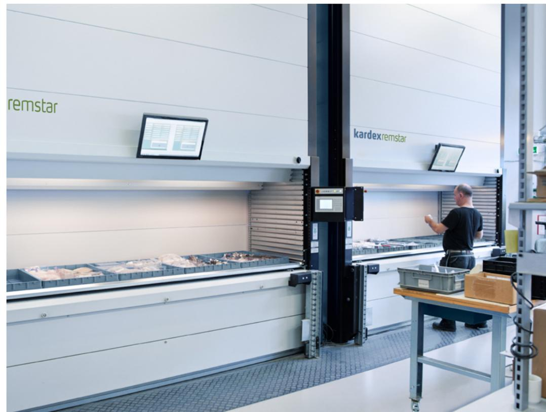
Vertical Lift Module consistono in due colonne di vassoi con un inseritore/estrattore meccanico posizionato al centro. L'inseritore/estrattore viaggia su e giù tra i vassoi immagazzinati, localizzandoli e recuperandoli automaticamente quando necessario – simile a un ascensore con porte che si aprono sia sul davanti che sul retro.
