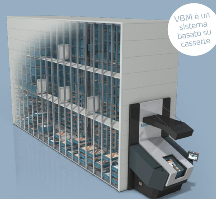
Un Vertical Buffer Module (VBM) è costituito da un sistema di scaffalature multi-segmento al cui centro è collocato un corridoio, in cui si muove un trasloelevatore dotato di pinza telescopica. Il controllore dell'unità mette in movimento la pinza, la quale preleva un determinato contenitore (o cassetta) e lo trasporta fino alla stazione di prelievo.
