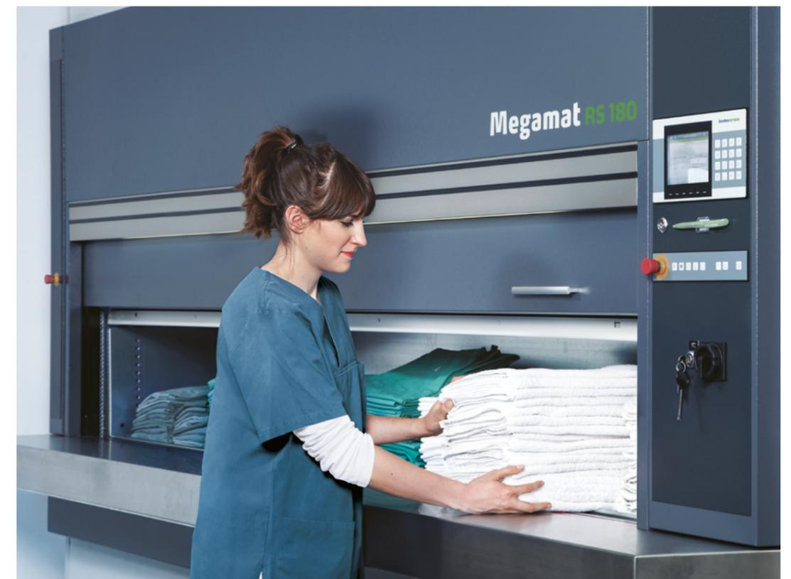
Vertical Carousel Module sono costruiti con una serie di supporti attaccati in posizioni fisse ad una trasmissione a catena. Il movimento dei ripiani in entrambi i sensi avviene attraverso una puleggia azionata da un motore, con supporti che si muovono su un binario su un percorso verticale.
