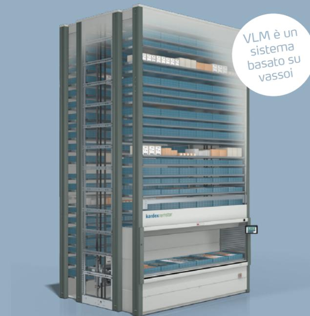
Un Vertical Lift Module (VLM) consiste in due colonne di vassoi con un gruppo di presa centrale automatizzato per l'inserimento e l'estrazione. Il gruppo di presa viaggia su e giù tra i vassoi immagazzinati, localizzandoli e recuperandoli automaticamente quando necessario – simile a un ascensore con porte che si aprono sia sul davanti che sul retro.
