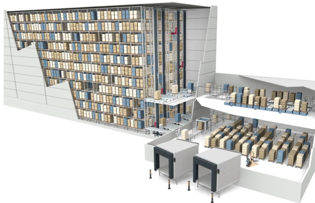
Magazzino refrigerato automatico
