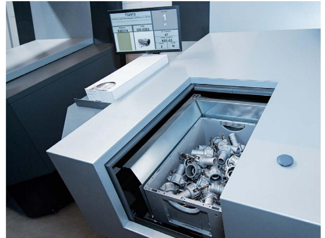
Bei einem VBM befindet sich in der Mitte des mehrstufigen Regalsystems eine Gasse, in der ein beweglicher Mast mit einem Teleskopgreifer arbeitet. Die Steuereinheit setzt den Greifer in Bewegung, dieser entnimmt einen Behälter und transportiert ihn zur Kommissionierstation.
