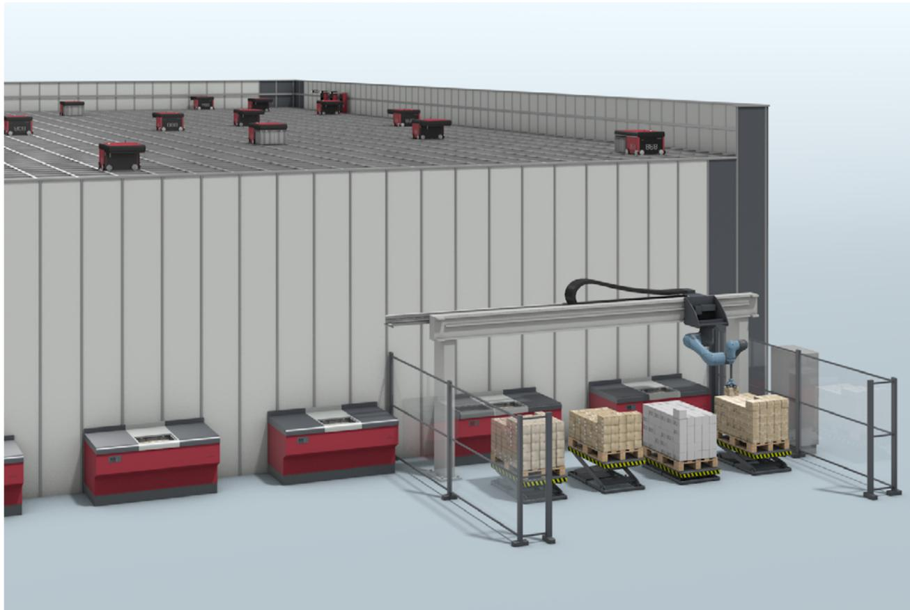
Solución automatizada con robots de picking y colocación para operaciones de paletizado y despaletizado
