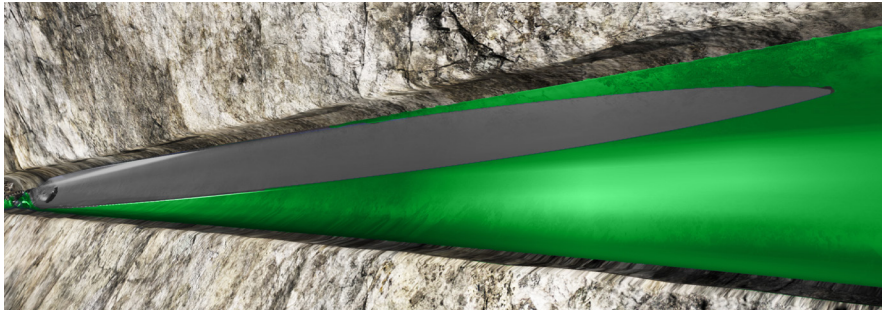
Клин-отклонитель, спроектированный для прохождения по нему буровых долот
