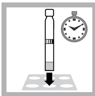
7. Colocar la cubeta en el reactor **precalentado**. Calentar la cubeta durante **2 horas**.
