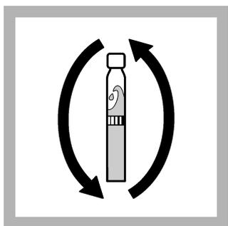
6. Sujetar la cubeta por la tapa sobre una pila. Agitar la cubeta 2–3 veces **cuidadosamente**. La cubeta se **calentará mucho** durante la mezcla.
