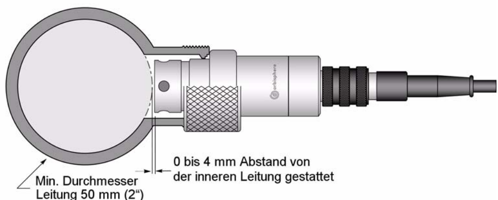
Abb. 3-1: Angeschweißter Sensorsockel
