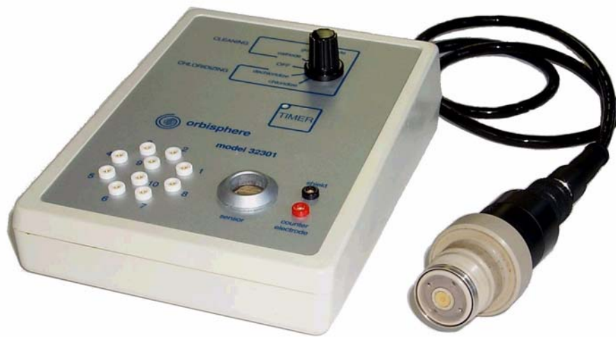
Abb. 4-1: Reinigungs- und Regenerierungszentrum Modell 32301
