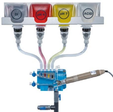
Suporte para sensores de pH Clean & CAL instalado com uma Sonda Diferencial Hach
