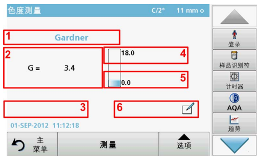
图 3 测量模式下的触摸感应区域
