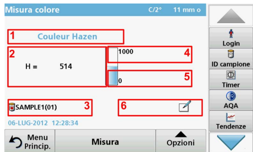
Figura 3 Aree a sfioramento in modalità di misura
