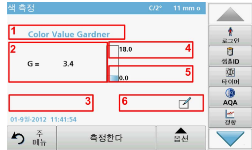
그림 3 측정 모드에서의 터치 감응 영역
