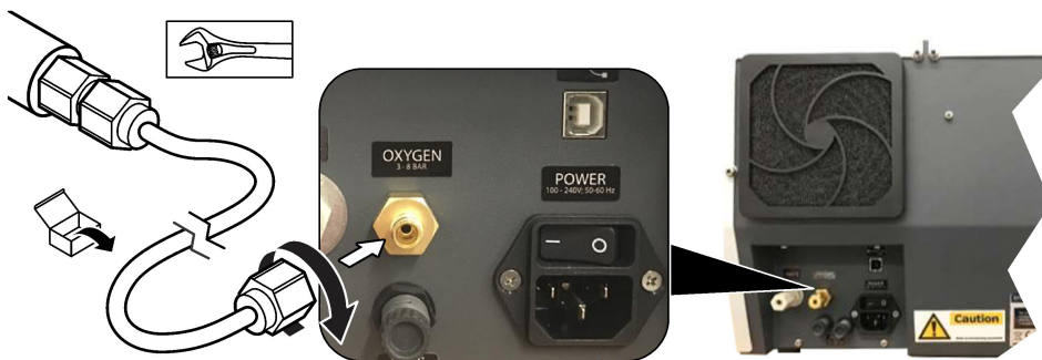
Slika 5 Priklučitev na nosilni plin
