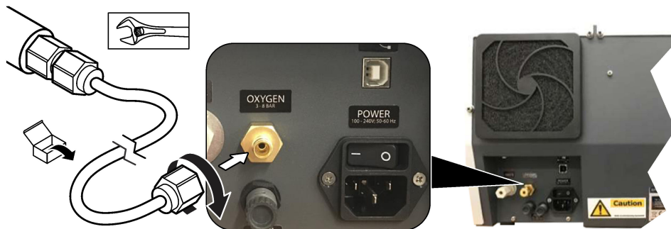
Εικόνα 5 Σύνδεση με φέρον αέριο
