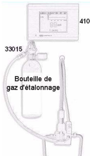
Une bouteille de gaz d'étalonnage  $N_2$  doit être raccordée à la chambre de circulation comme illustré à gauche.
