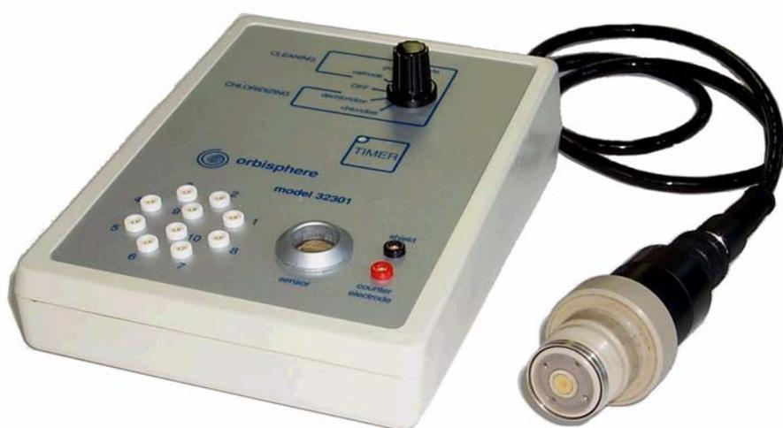
Fig 4-1: Centre de nettoyage et de régénération - Modèle 32301
