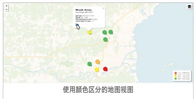
图 3.连续液相监测的远程访问选项让操作员可以每分钟深入查看高度准确的 H<sub>2</sub>S 状态（按时间和温度显示），包括使用颜色标识的仪表板视图，从而轻松识别新出现的问题热点。
