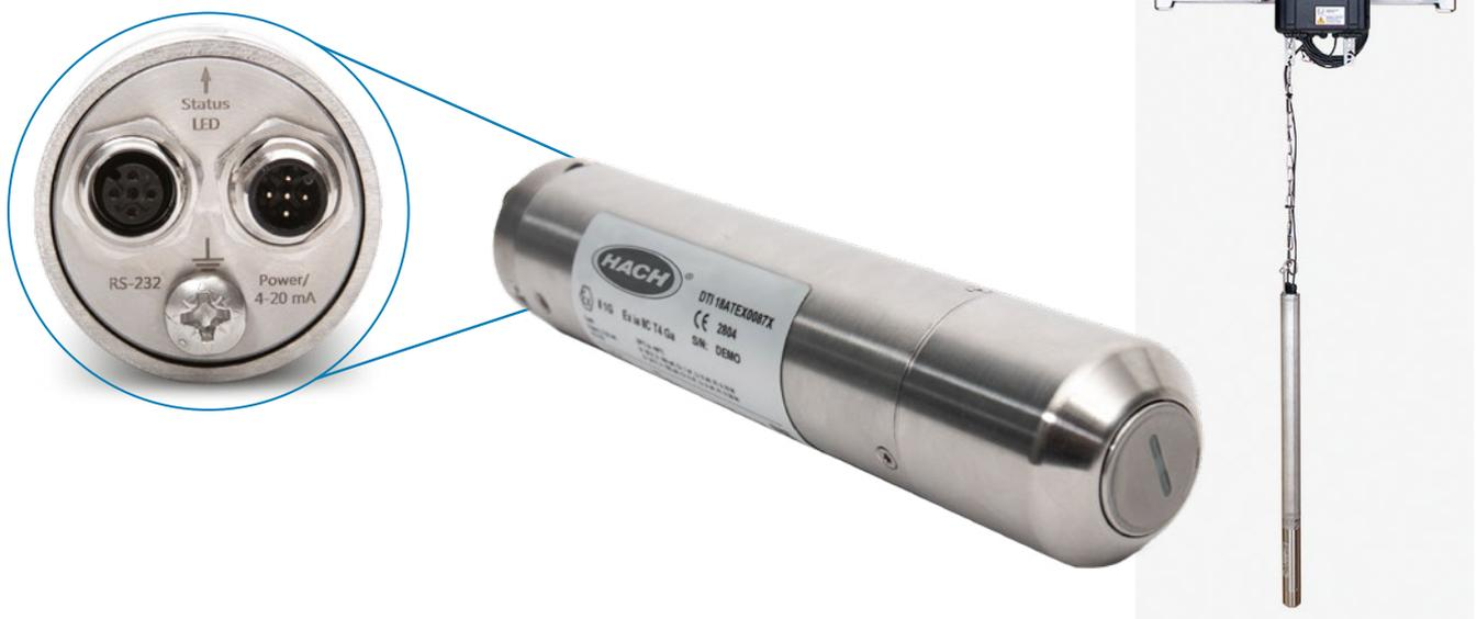
图 2. 这种结构紧凑、维护工作量少的电化学传感器装有不锈钢外壳、采用防垢设计和行业标准密封连接 (如图所示), 当浸没在废水中使用以及用于各种气相环境时均能提供强大的性能。它可提供  $\pm 5\%$  的准确度, 检测限值为全量程的 1%。对于液体测量, 同一款传感器的报告精度可达毫克/升 (mg/L), 对于气体/空气测量, 报告精度可达百万分率 (ppm)。标准支架组件 (嵌入件) 可在典型的人孔位置实现快速且方便的安装。
