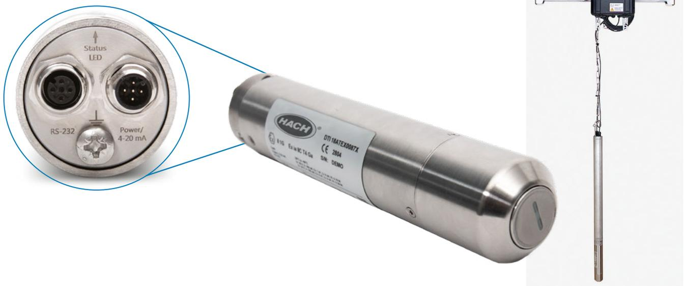
図 2. このコンパクトでメンテナンスの少ない電気化学センサは、ステンレス製ハウジング、防汚設計、業界標準の密閉型接続部 (図示) を備えており、水中廃水や気相利用でも堅牢な性能を発揮します。検出限界がフルレンジの 1 % で、 $\pm 5\%$  の精度を実現しています。同じセンサで、液体測定ではミリグラム/リットル (mg/L)、気体/空気測定では百万分率 (ppm) の単位でレポートできます。標準のブラケットアセンブリー (はめ込み式) により、一般的なマンホールの場所に迅速かつ簡単に取り付けることができます。
