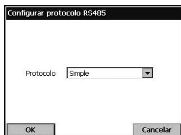
El puerto RS-485 de la placa principal está conectado directamente a un bus RS-485 (par trenzado individual). Opcionalmente, se puede conectar a un módulo fieldbus (gateway). En este caso, el módulo fieldbus tiene un puerto RS-485 conectado al bus RS-485.
