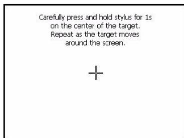
Esta pantalla de Windows CE le permite ajustar la posición de clic correspondiente a los botones mostrados. Utilícela si las áreas sensibles no aparecen alineadas adecuadamente con los botones de la pantalla. Siga las instrucciones de la pantalla:
