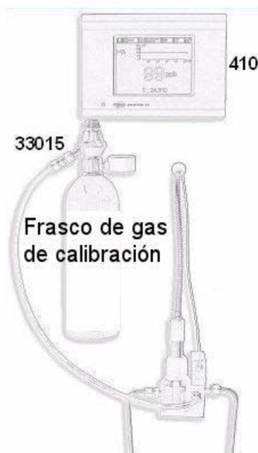
Debe conectarse un frasco de gas  $N_2$  de calibración a la cámara de flujo, como se muestra a la izquierda.
