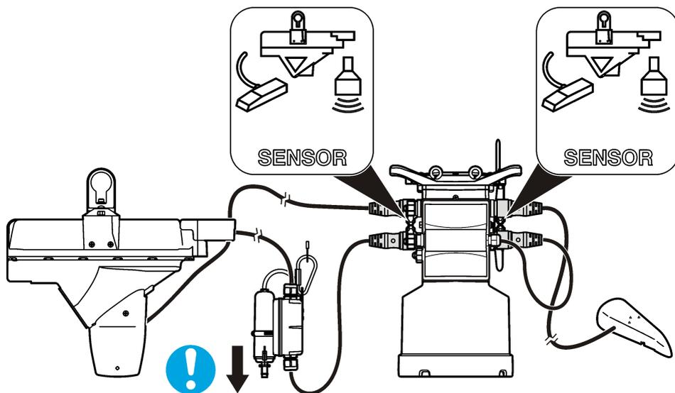
**Figure 7 Raccordement d'un capteur à un module externe**
