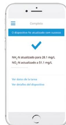
Calibração do instrumento de processo concluída
