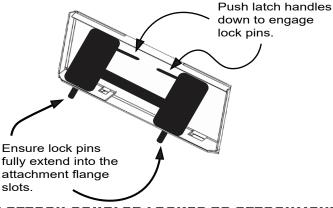
FIGURE 3.2B OUICK ATTACH COUPLER LOCKED TO ATTACHMENT PLATE
