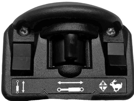
**FIGURE 4.6A TYPICAL MACHINE AUXILIARY ELECTRIC CONTROLLER**
