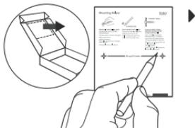
**B.** Fija los tornillos en los agujeros dejando un espacio de 3 mm con la pared para que haya espacio suficiente para instalar el dispositivo.
