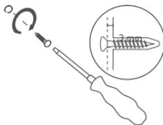
**C.** Posiziona l'Ottimizzatore Pompa di Calore X sulle viti e fallo scivolare verso il basso per montarlo.
