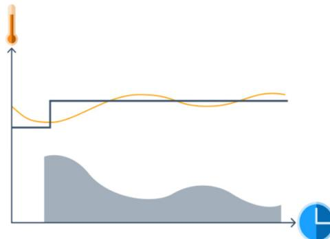
En sistemas digitales o modulantes, según la demanda de calor, el sistema de calefacción modula la cantidad de calor suplida para alcanzar y mantener una temperatura dada.
