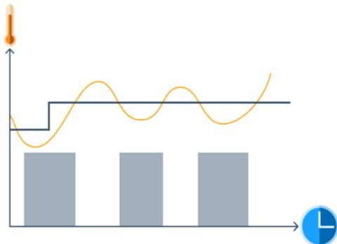
La calefacción se enciende (100%) y se apaga (0%) completamente por ciclos de tiempo específicos basados en la demanda de calor.
