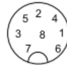
Abbildung 9: Sicht auf Lötanschluss der Kabeldose
