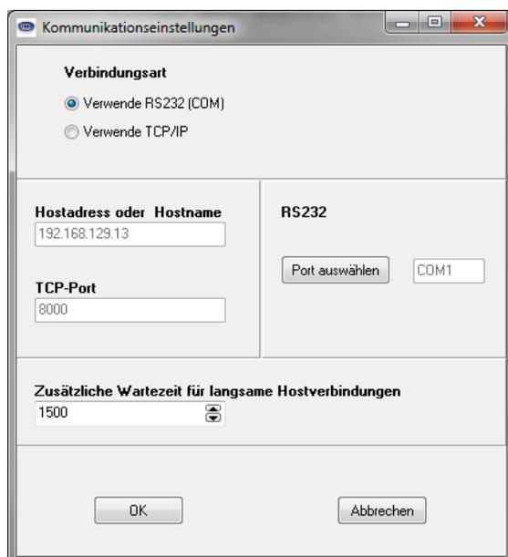
Soll eine Verbindung zu UMB Geräten über LCOM-Serviceprogramm und Lcom hergestellt werden, ist zunächst das LCOM Serviceprogramm (Version 2.0 oder neuer) zu starten und damit eine Verbindung zur Station herzustellen. Danach kann man mit dem UMB Config Tool mit den Verbindungseinstellungen
