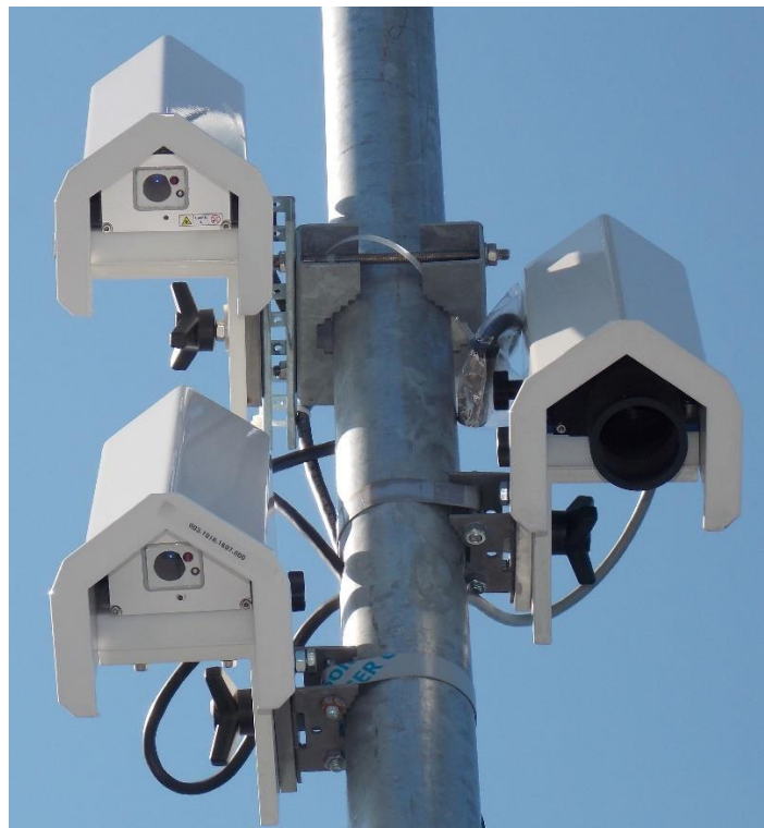
Abbildung 12: SHM31 Sensoren mit Mastschelle 8365.610-11 (oben links), Mastschelle 8365.608-11 (unten links) und SHM30 Sensor mit Mastschelle 8365.608-11 (mitte rechts).
