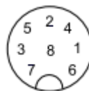
Abbildung 17: Sicht auf Lötanschluss der Kabeldose mit Nut.
