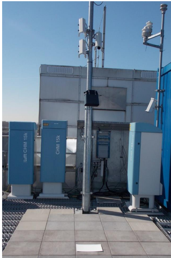
Abbildung 31: Prüfung der Signalqualität mit der Weißkarte 8365.KWK-WS
