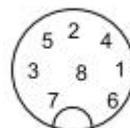
Abbildung 26: Sicht auf Lötanschluss der Kabeldose
