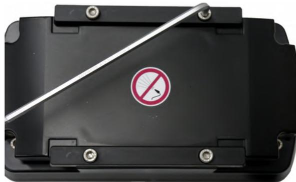
Abbildung 6: Schrauben auf dem MARWIS-Gehäuse lösen
